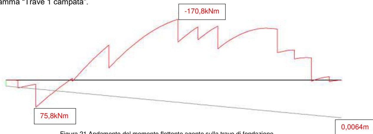
Figura 21 Andamento del momento flettente agente sulla trave di fondazione
