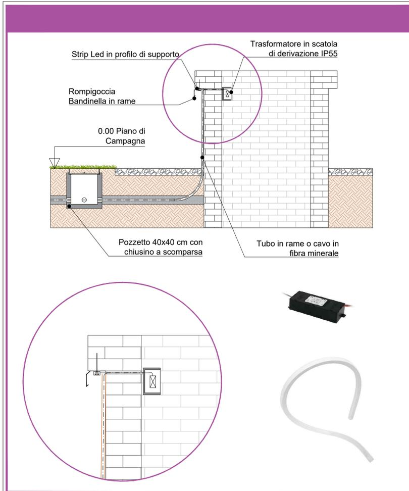
PARTICOLARE COSTRUTTIVO: SEZIONE POZZETTO
