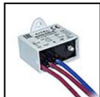
S.2499 SCARICATORE SOVRATENSIONE 10kV CLASSE II Compatibile con tutti gli apparecchi di illuminazione in Classe di Isolamento CLASSE II Tensione di funzionamento 230-277V SPD type 2+3 Tensione massima di scarica 10kV grado di protezione IP67
